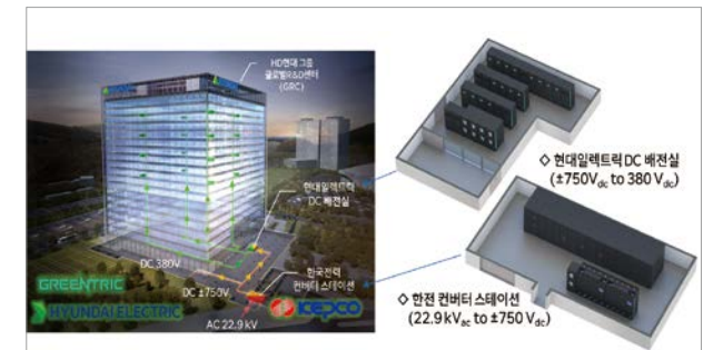
세계 최초 MW급 빌딩용 직류전원 공급시스템
